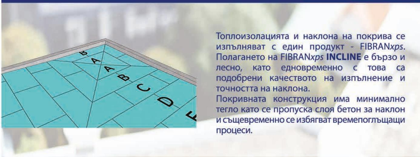
Топлоизолацията и наклона на покрива се изпълняват с един продукт - FIBRANxps. Полагането на FIBRANxps **INCLINE** е бързо и лесно, като едновременно с това са подобрени качеството на изпълнение и точността на наклона.
